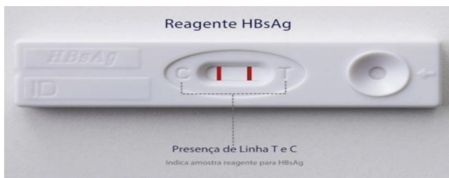
Figura 1 – Interpretação de resultado reagente no kit HBsAg Bioclin.
